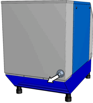
Рис. 20: Подключение сжатого воздуха
