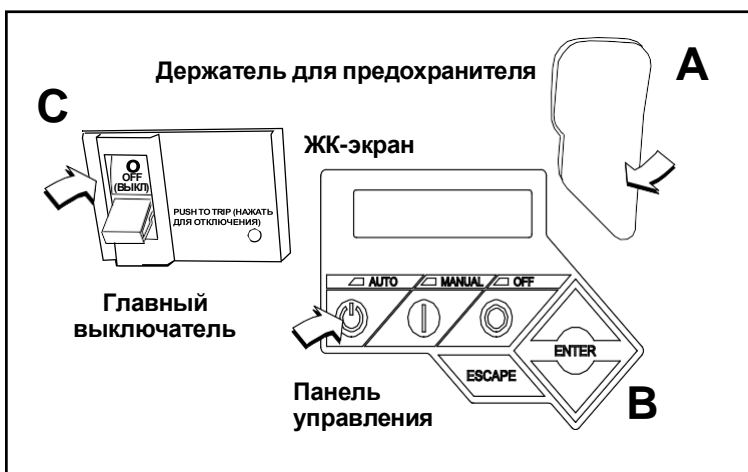
Рис. 5-16. Панель управления генератора
